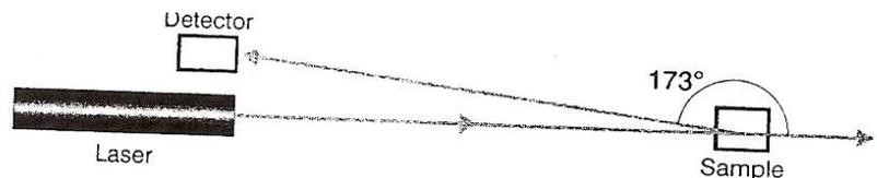
**Рис. 2.5.** Принцип обратного светорассеяния
