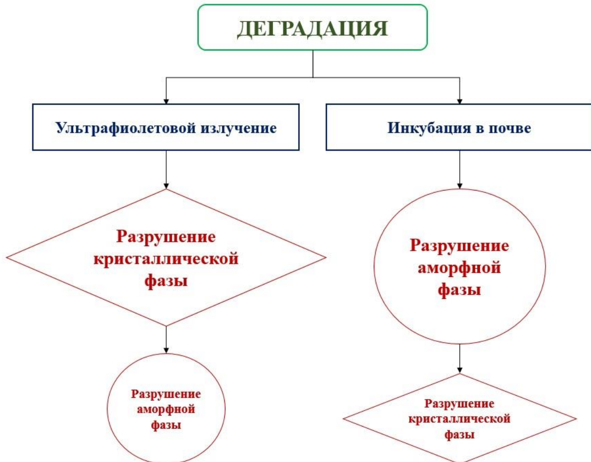
Рисунок 52 – Схема влияния УФ-излучения и почвы на разрушение фаз полилактида.
