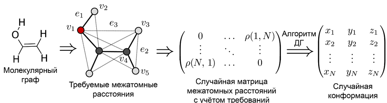
Рисунок 1. Принцип конформационного перебора методами дистанционной геометрии.
