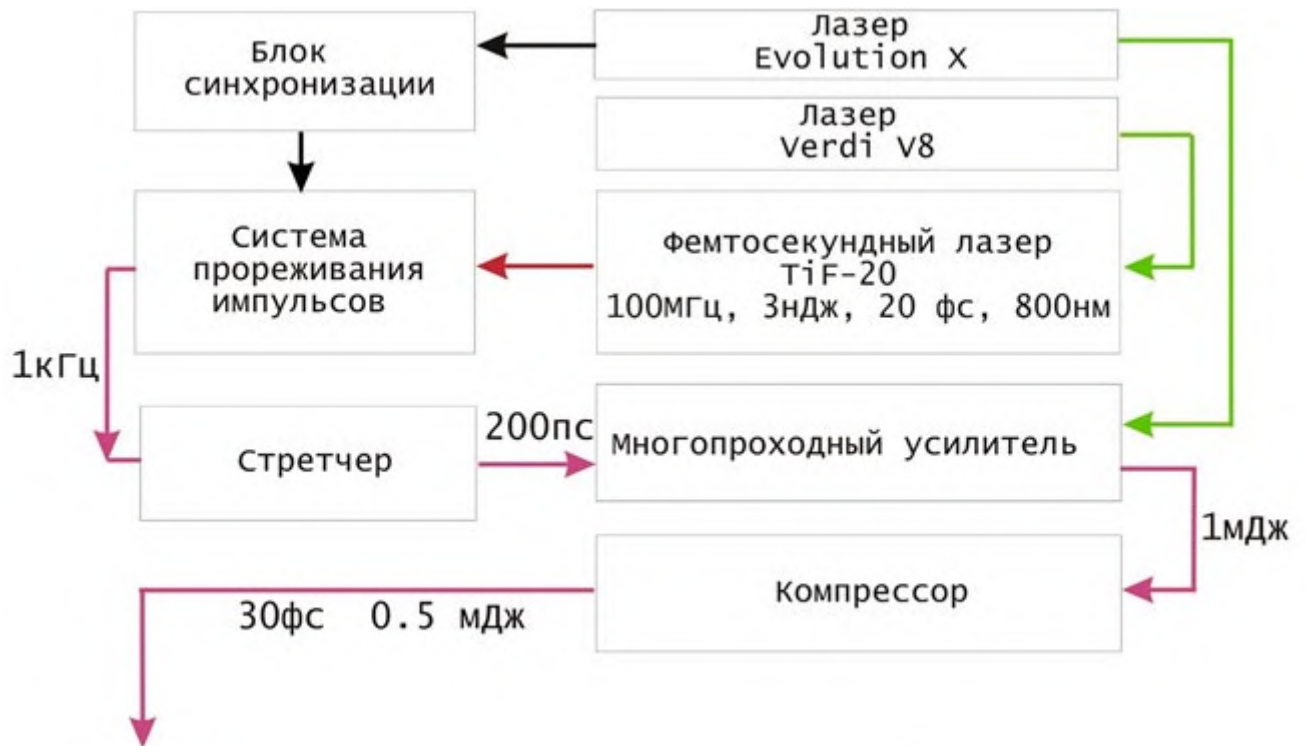
Рисунок 2.2 – Схема приготовления исходных фемтосекундных импульсов
