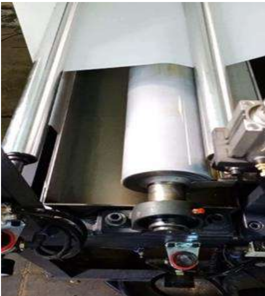
Стадия обработки огнезащитным составом полиэфирной ткани
