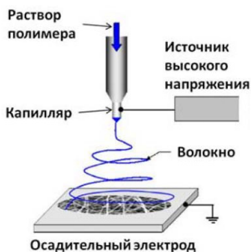
Рисунок 3. Схема метода электроформования (слева) Нетканый волокнистый материал на основе ПГБ (справа)
