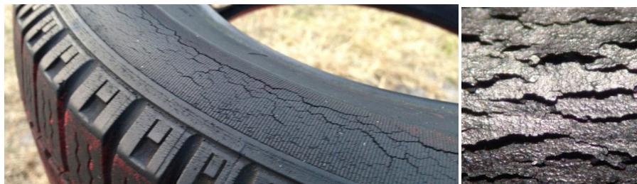
Рисунок 4. Влияние атмосферного озона на трещинообразование шин в процессе эксплуатации
