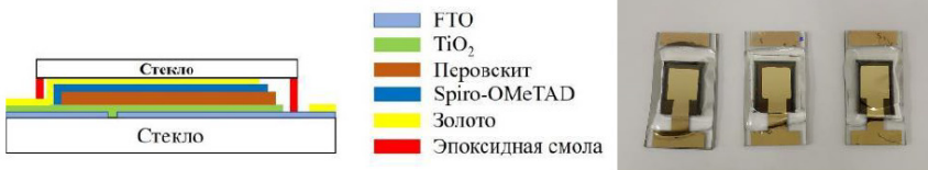
Рис. 2.1.6. Схема герметизации образцов ПСЭ (слева) и общий вид герметизированных образцов ПСЭ с рабочей площадью около 1 см² (справа).
