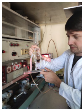
Рис. 1 Светодиодные модули для фотовозбуждения (365 нм, 620 нм) и кювета с образцом в блоке для фотооблучения
