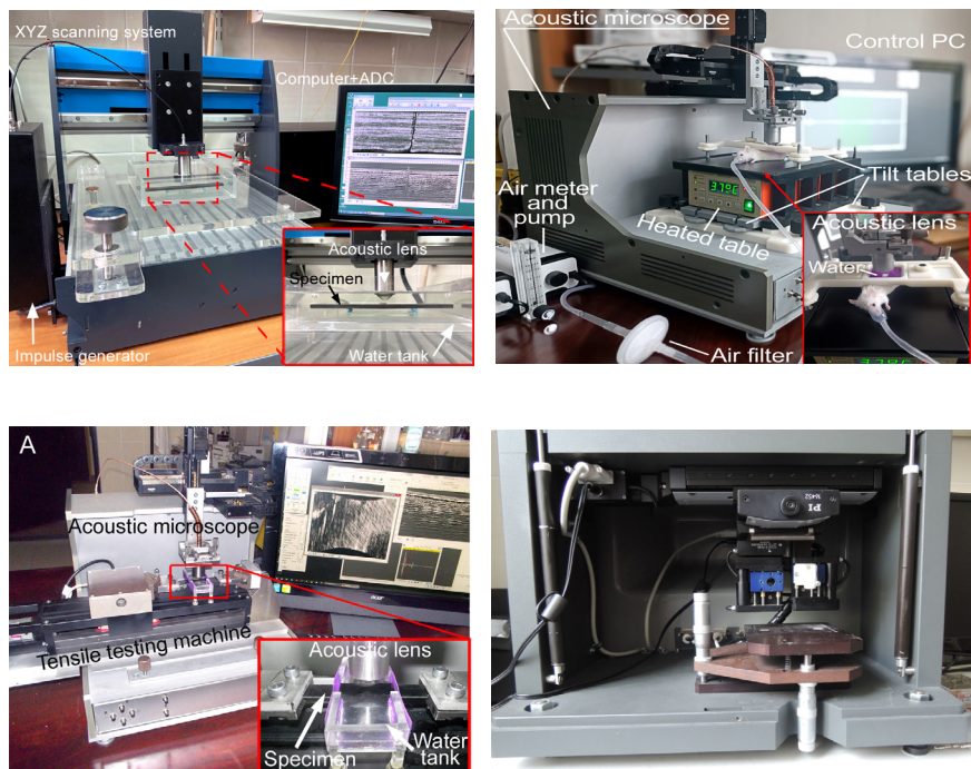
Рисунок 2. Линейка импульсных акустических микроскопов, разработанная в ИБХФ РАН: исследовательский микроскоп SIAM-2010 (из статьи [2]); исследовательский микроскоп SIAM-2017 с приставкой для исследований мелких лабораторных животных (из статьи [3]); исследовательский микроскоп SIAM-2017совмещенный с горизонтальной машиной мех. нагружения (из статьи [1]); ЛЧМ акустический микроскоп SIAM-LFM. 1.
